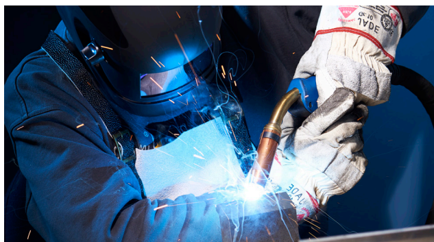
Sérült szerszám hegesztése (MAG)
