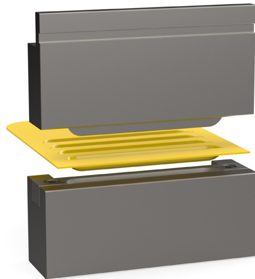
Egyszerű kivitelű kopoltyúzó szerszám
