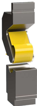
Állomás 1: Profil előhajlítása két lökettel
