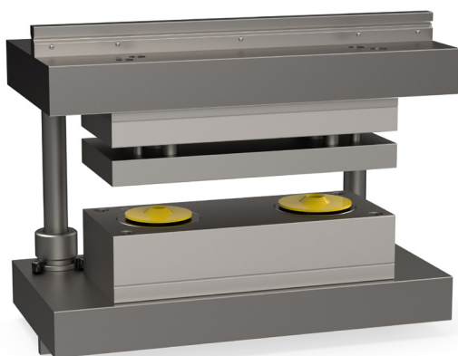
Oszlopos megvezetésű présszerszám két profil előállítására egy lökettel
